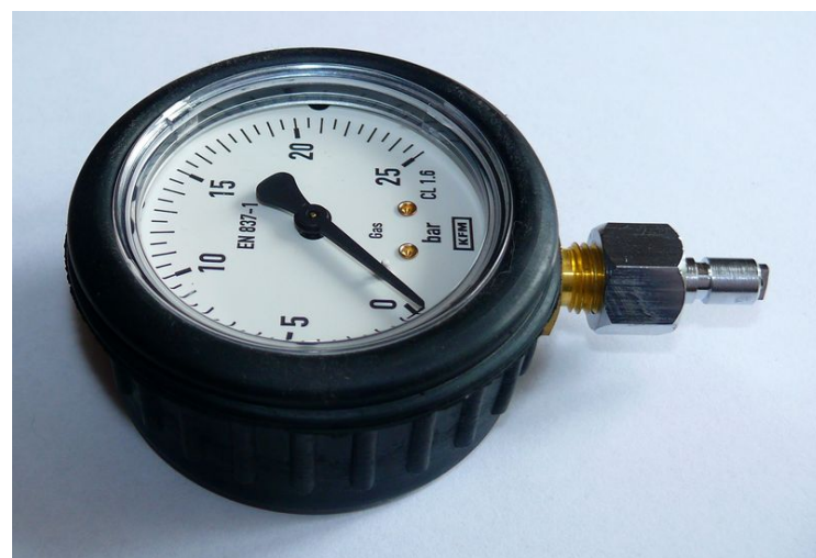
Manometr międzystopniowy - do regulacji i sprawdzania ciśnienia międzystopniowego w automatach z przyłączem jacketowym.
