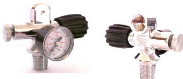
Zawór z manometrem do butli matek na potrzeby PCP i paintballa z gwintem do butli M25X2 r. katal. 10119, z gwintem M18X1,5 nr katal. 10116
