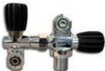
Zawor podwójny H DIN/INT Prawy 10081 gwint do butli M25X2 (na zamówienie 3/4" lub 17E)
