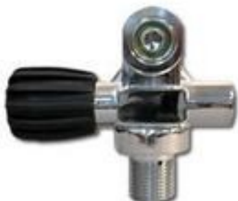
Zawor pojedynczy centryczny DIN/INT Lewy nr katal. 10147 – do manifolderu (możliwy montaż rozbudowy – na zamówienie). Gwint do butli M25X2 (na zamówienie 3/4" lub 17E)
