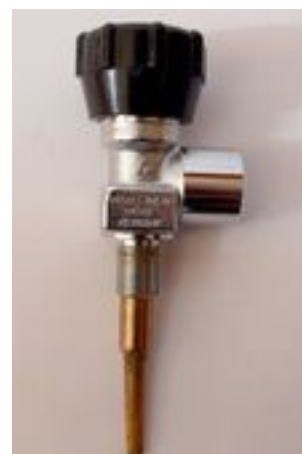
Zawór pojedynczy AUER DIN 300 bar gwint do butli M18X1,5
