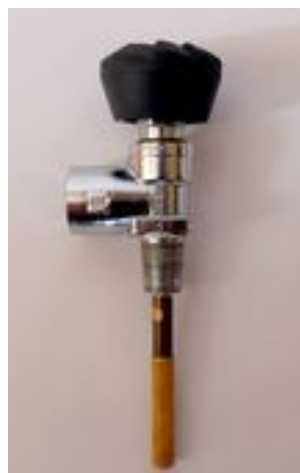
Zawór pojedynczy AUER/MSA DIN 300 bar gwint do butli M18X1,5 lub 17E
